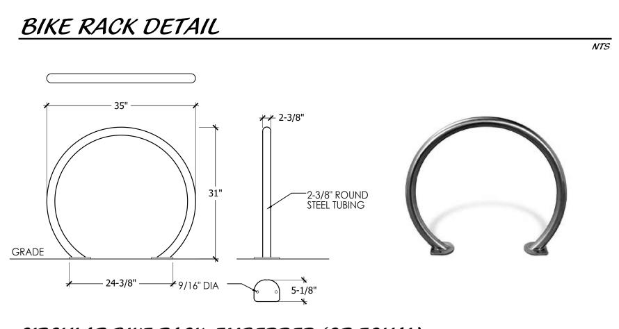
CIRCULAR BIKE RACK, EMBEDDED (OR EQUAL) BELSON OUTDOORS MODEL - CBBR-2CR-SS STAINLESS STEEL, SURFACE MOUNT WWW.BELSON.COM
