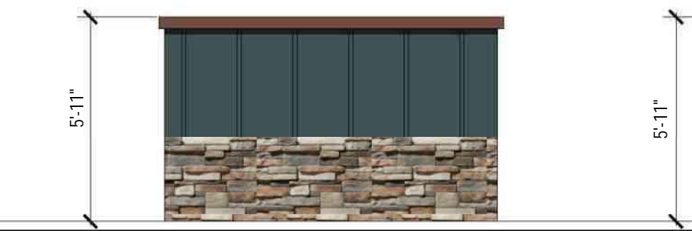
13 RIGHT/LEFT ELEV TRASH ENCL SCALE: 1/4" = 1'-0"
