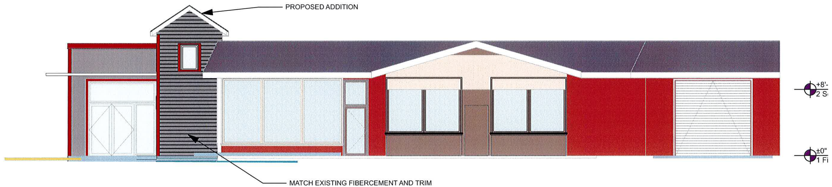
2 East Elevation Scale: 1/8" = 1'-0"
