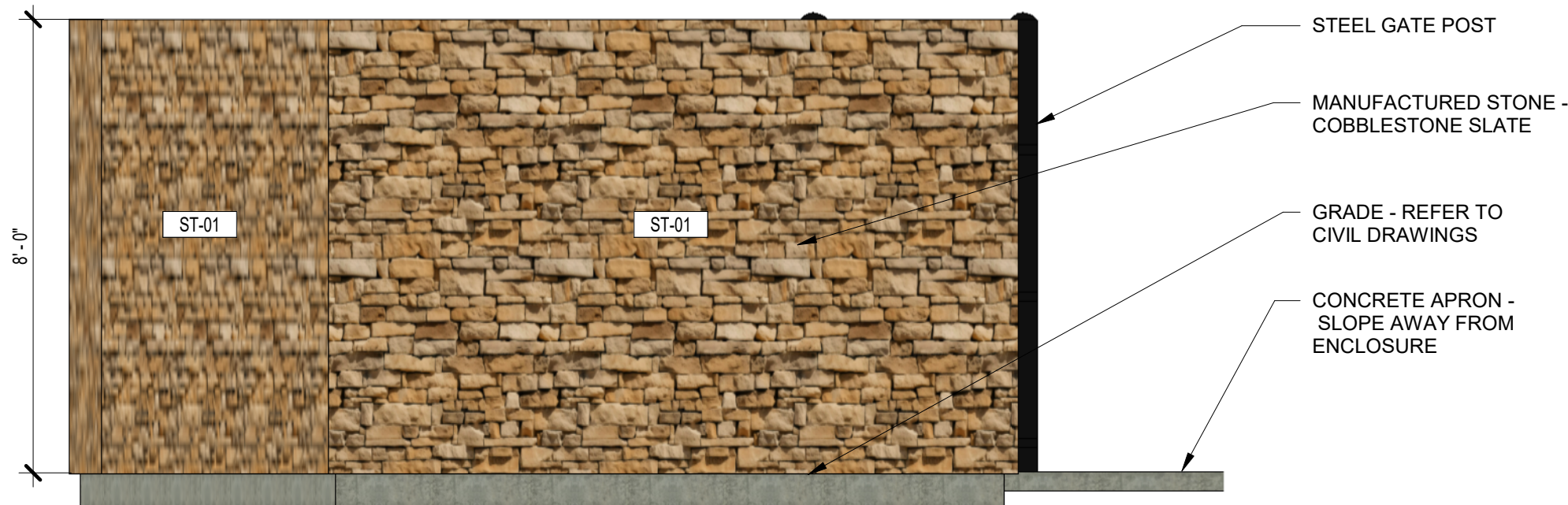
2 WEST ELEVATION - DUMPSTER SCALE: 3/8" = 1'-0"
