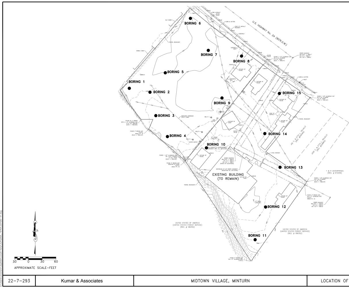
Fig. 1 LOCATION OF EXPLORATORY BORINGS
