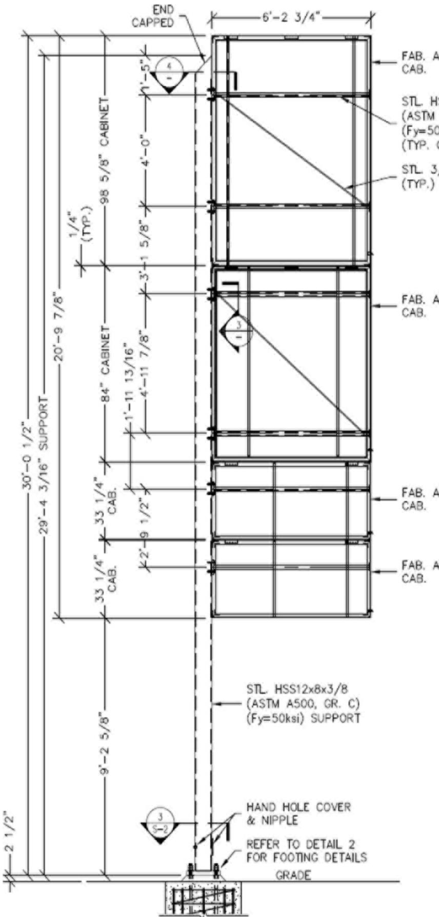
FAB. ALUM. EXTRUD. CAB. STL. HSS4x2x1/4 (ASTM A500, GR .C) (Fy=50ksi) SUPPORT ARM (TYP. OF 6)
