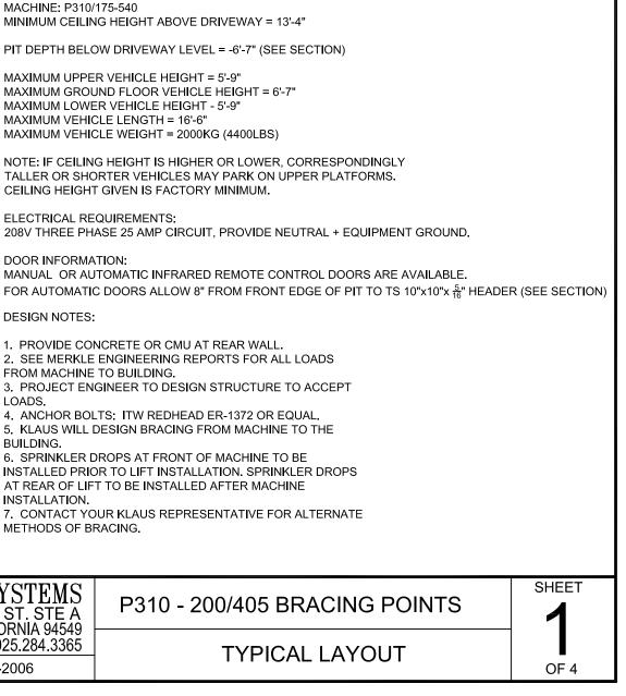
M:\P 310\Drawings\P310-200-405\P310-200-405 typical bracing 12-12-06.dwg
