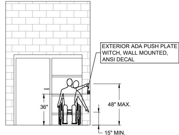
2 DOOR #3. EXIT DOOR EXTERIOR FRONT ELEVATION
