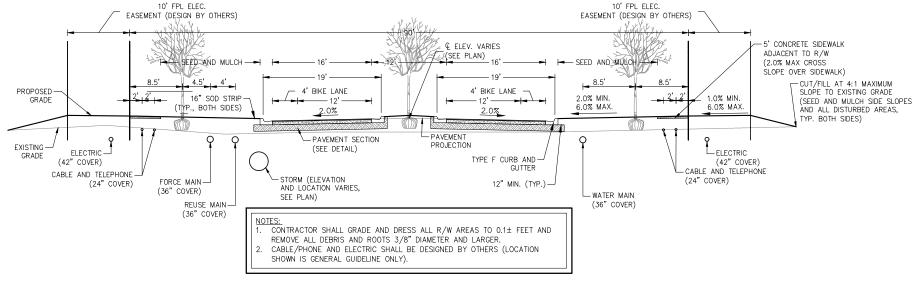
TYPICAL ROADWAY CROSS SECTION FOR 90' RIGHT OF WAY
