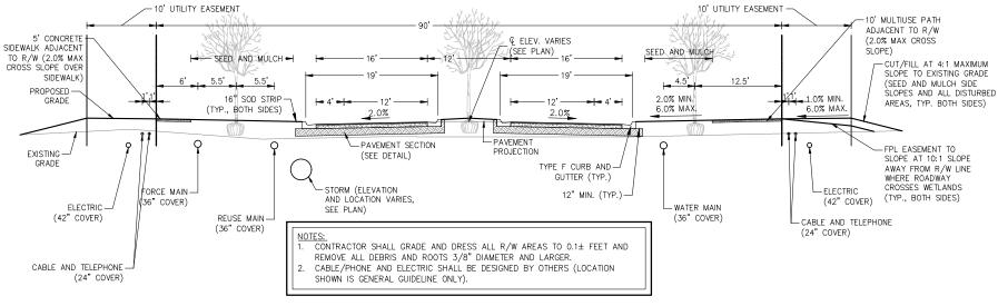
TYPICAL ROADWAY CROSS SECTION FOR 90' RIGHT OF WAY
