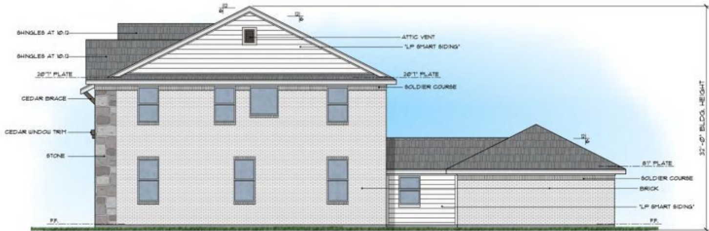
RIGHT ELEVATION '3 UNIT' 1/4"=1'-0"
