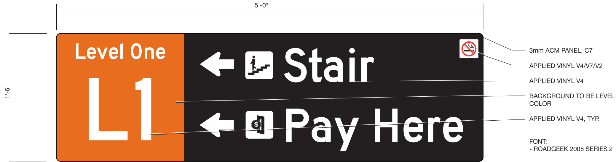
A SIGN ELEVATION - L1.004 10.00 SCALE: 1 1/2" = 1'-0"
