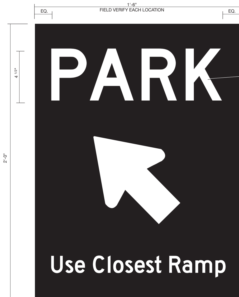
A SIGN ELEVATION 18.00 SCALE: 3" = 1'-0"
