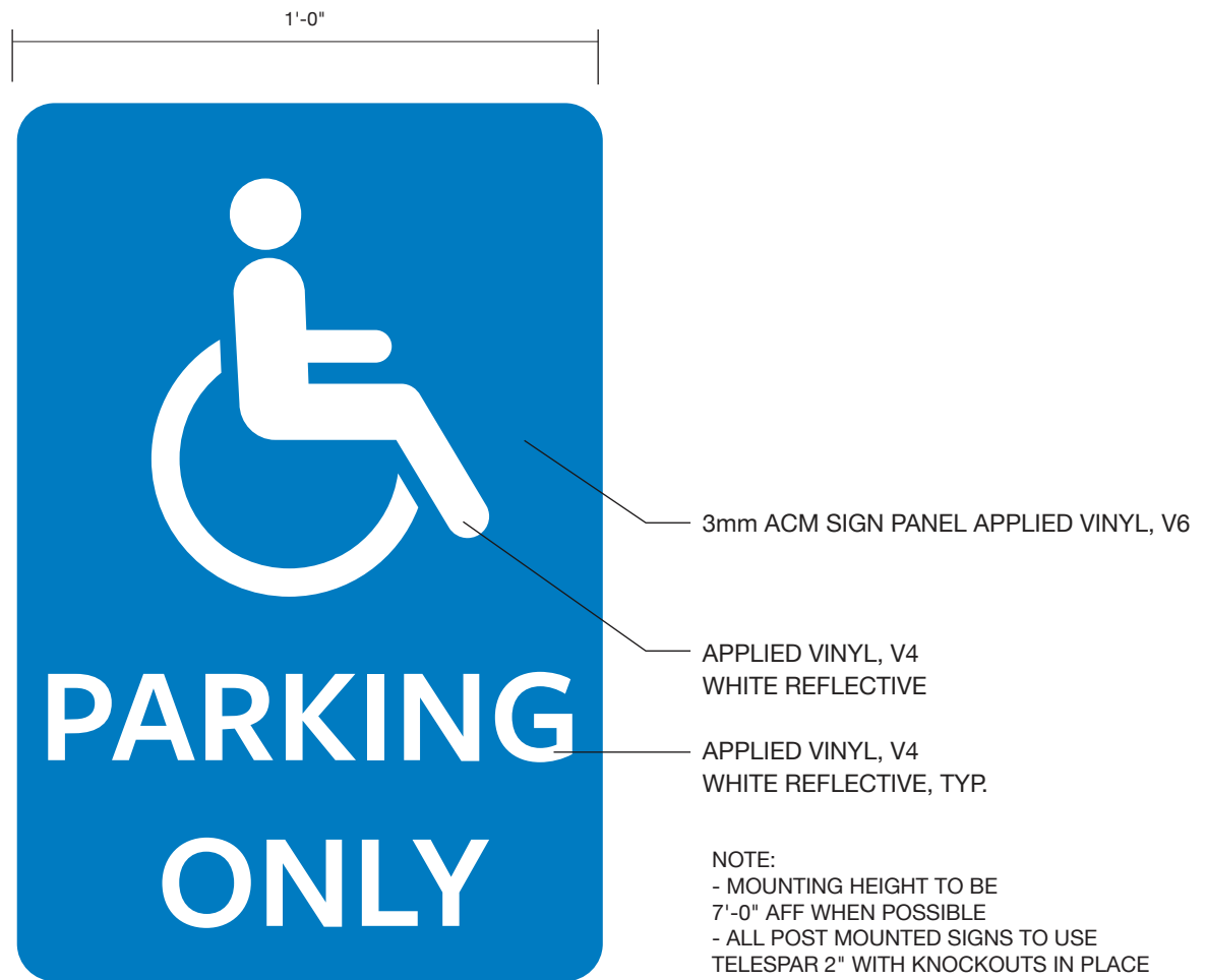
B SIGN ELEVATION 9.00 SCALE: 3" = 1'-0"
