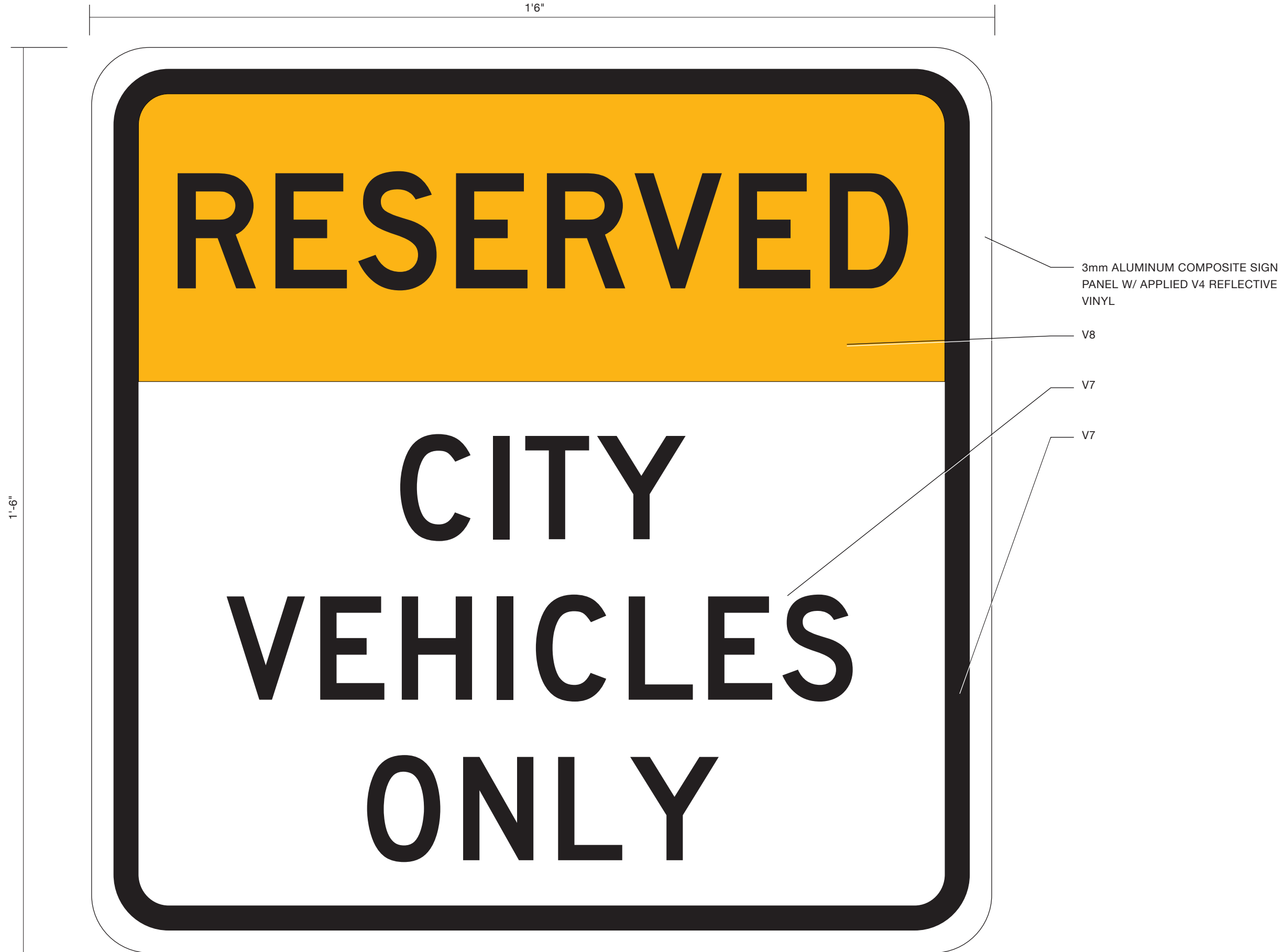
A SIGN ELEVATION 8.00 SCALE: 1:2
